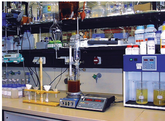
Einfache Laborapparaturen zum Test von Nassoxidation, Flockung/Fällung, Adsorption und Extraktion
